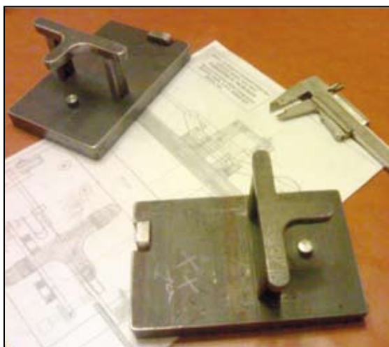
Foto 6 - Le due basi e il mainframe assemblato.
