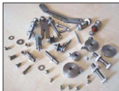
Foto 7 - Le parti in acciaio AISI 316 che compongono il bug
