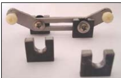
Foto 5 - Particolare del prototipo della barretta con gli isolatori per i contatti elettrici.
